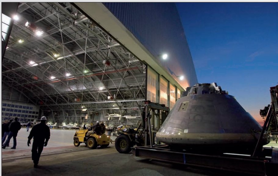
Полноразмерный макет командного модуля космического корабля Orion был доставлен на исследовательскую базу NASA в Ленгли для проведения натурных испытаний Системы аварийного спасения (LAS)
